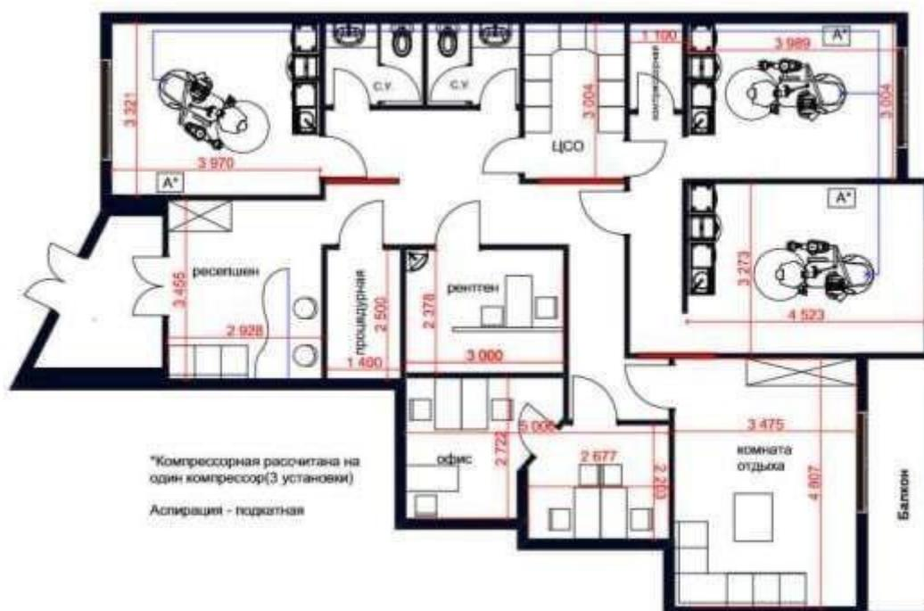
Рис. 1. Схема помещения и размещения в нем оборудования
