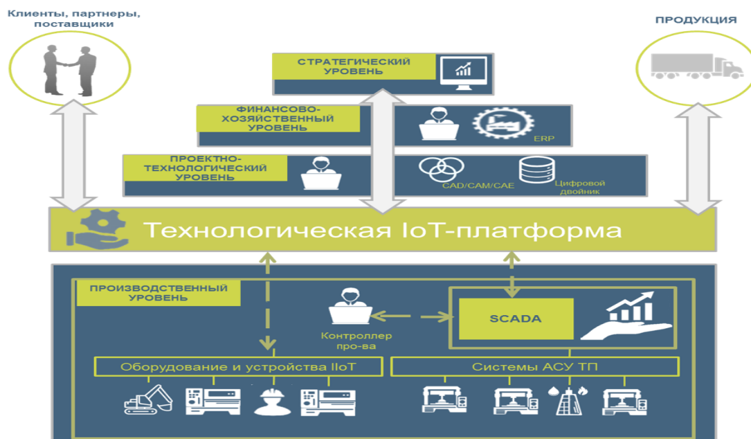
Рис. 1. Схема интернета вещей предприятия с технологической IoT-платформой [5].
