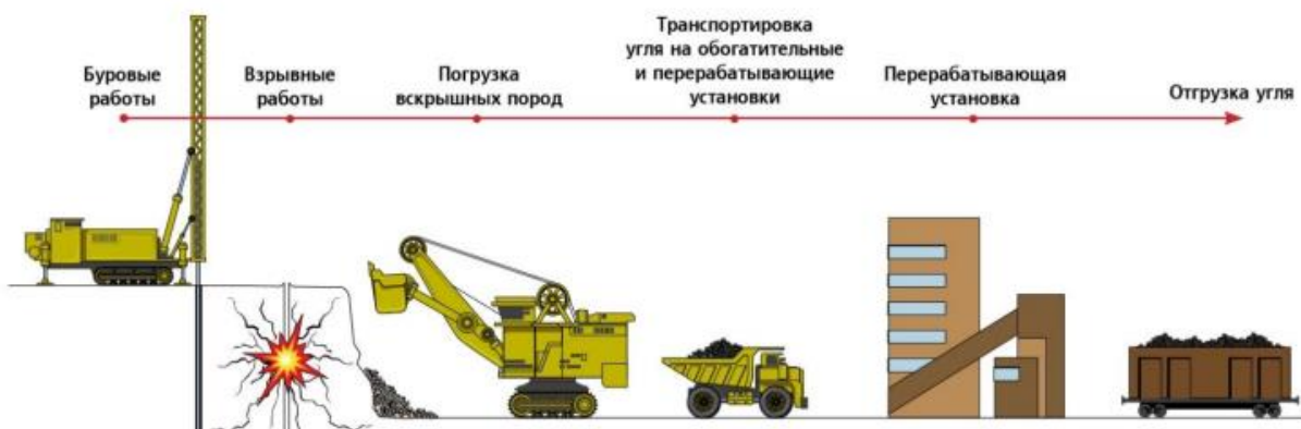
Рис. 2. Схема процесса добычи угля
